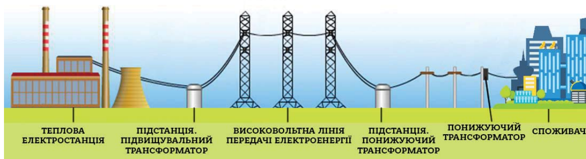
Мал. 89. Схема передачі електроенергії споживачам від ТЕС
